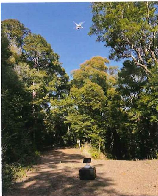
写真1 高精度GPS測位可能なドローン (P4 Multispectral)
